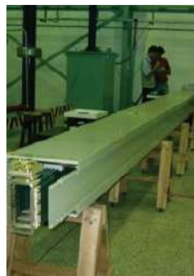
Ensaio de aquecimento, dielétricos e de nível de ruído IPTB-FURB (Blumenau)
