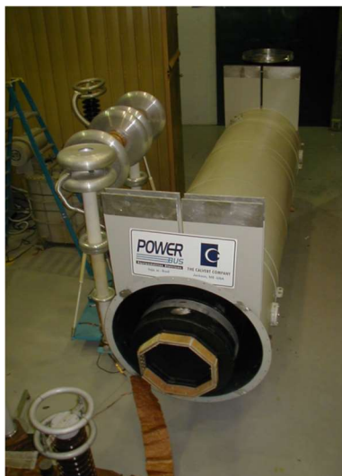
VOITH SIEMENS Hydro UHE ITAIPÚ 9 A/18A - 737/823,6MVA 2x18kV-30000A Ensaio de tipo CEPEL (recorde mundial 33kA em vent. natural)
